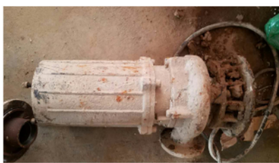
图 1 被拆解后的故障潜污泵
