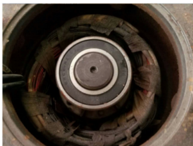
图4 被烧毁的定子线圈
