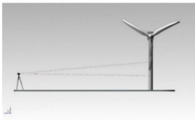
图3 视频检测叶轮不平衡示意图
