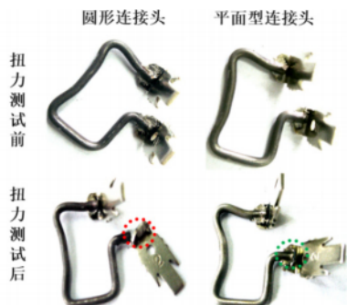
图 4 不同形状连接头扭力测试前后外观对比
