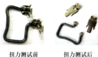
图 2 优化焊接参数扭力测试前后外观对比
