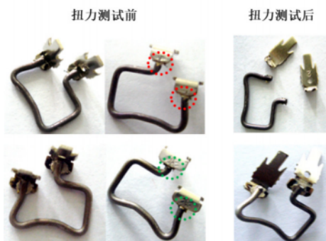
图6 不同表面积端子板扭力测试前后外观对比
