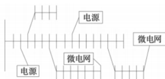
图 2 IEEE 33 节点配电网测试系统结构图
